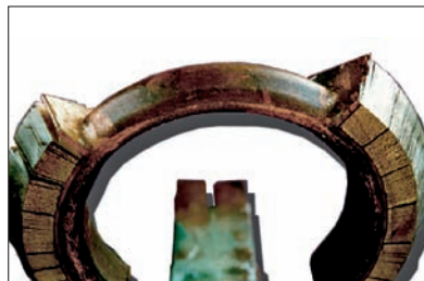
Bild 28: Konzentrator aus Weicheisenblechen
