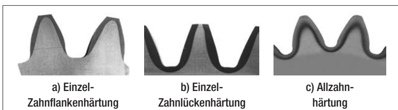
Bild 46: Beispiele induktiv gehärtete Zahnräder (Makroschliffe)
