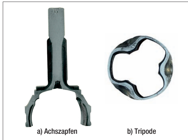
Bild 43: Induktiv gehärteter Achszapfen und Tripode
